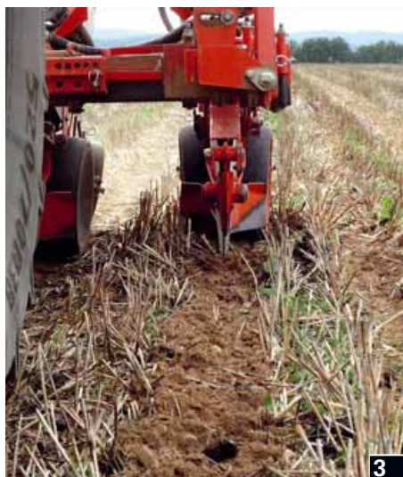
Foto 3 e 4 La larghezza della striscia lavorata deve essere di dimensioni commisurate all'elemento di semina (3). L'elemento della seminatrice che opererà sulla fascia lavorata è preferibile che sia dotato di utensili sparti-residuo al fine di poter allontanare senza difficoltà eventuali residui presenti sulla striscia, specialmente nel caso di semina di colture intercalari, dove l'intensità della lavorazione viene ulteriormente ridotta allo scopo di contenere le perdite di umidità (4)
