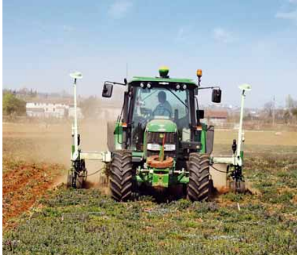
Foto 2 Lo strip-tillage si presta all'adozione di un sistema di guida assistita. Velocità sostenute e l'esigenza di un'alta precisione in fase di semina rendono l'utilizzo del tracciabile spesso non sufficiente per una corretta operatività
