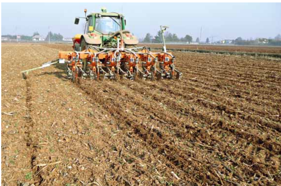
Il trattore, equipaggiato con guida satellitare, avanza a circa 7 km orari e il coltivatore crea le 6 strisce distanti tra loro 75 cm
